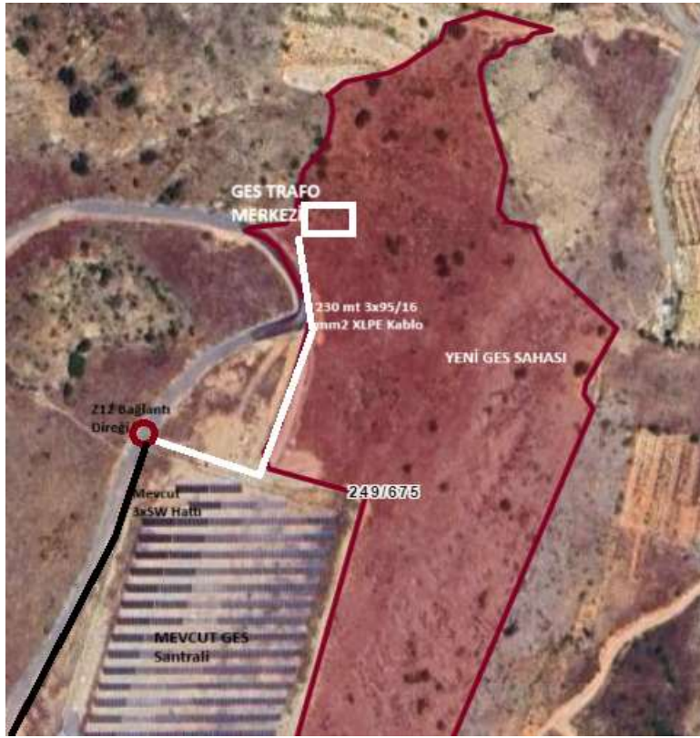
Şekil 3. Enerji Nakil Hattı
